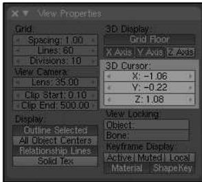
**Figura 7.5:** Posicionamiento numérico del cursor 3D.
