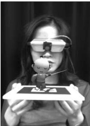
**Figura 3.1:** Uso de ARToolKit en un dispositivo de visión estereo.
